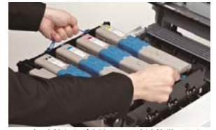
ハンドルを持ち上げるだけで、用紙を簡単に取り除ける「バスケット方式」を採用。
